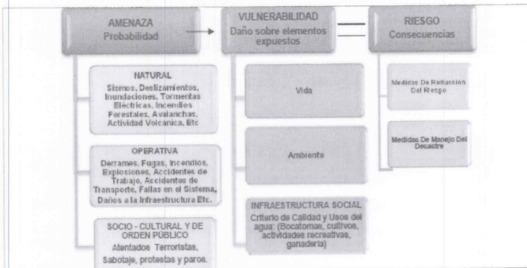
Figura 1. Esquema general para el análisis de riesgos.
